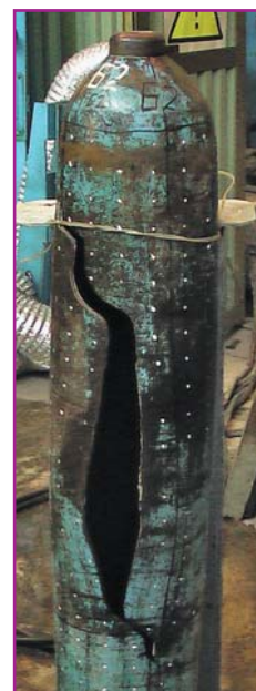
Фото 1. Разрушение баллона при его освидетельствовании
