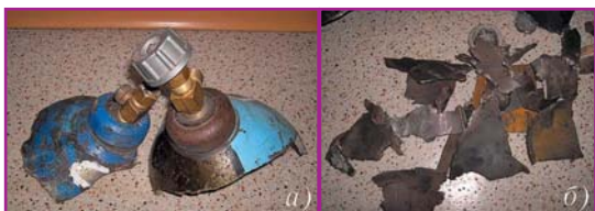
Фото 2. Части горловины (а), осколки корпуса и днища (б) взорвавшихся баллонов
