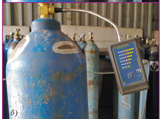
Фото 3. Проверка на истекающей струе наличия горючего газа с помощью сигнализатора: а — сигнал отсутствует (баллон «чистый»); б — сигнал присутствует (баллон «заражённый»)
